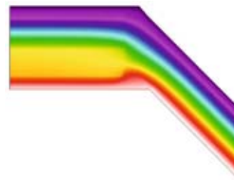
Abb. 6: Wärmebrücke Traufe (Konstruktion und Isotherme)
